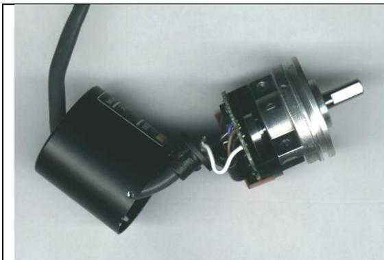
***Fotografía de un encoder incremental***
