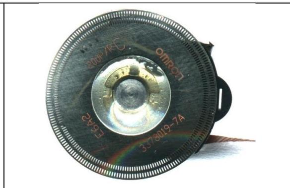
***Detalle de la lámina perforada***
