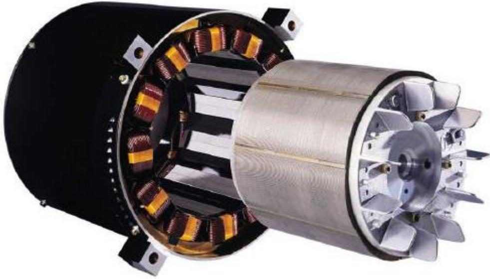
Los servomotores más utilizados en la industria actualmente, son los motores de corriente alterna sin escobillas tipo Brushless. Básicamente están formados por un estator segmentado en el que el espacio relleno de cobre es casi el doble que en los motores tradicionales, esto permite desarrollar una mayor potencia con un menor volumen.
